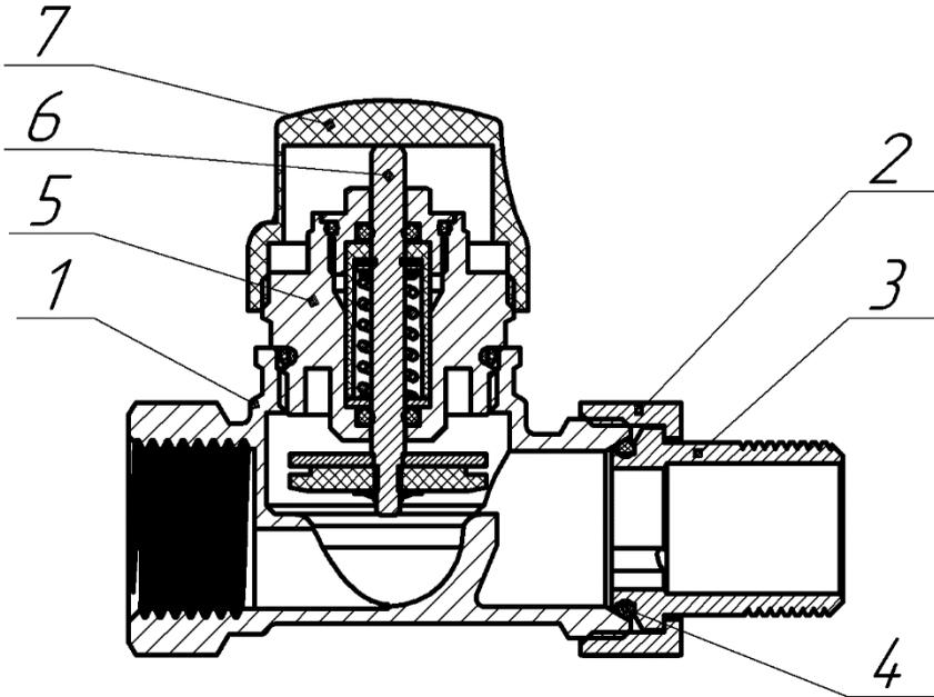
Рисунок 7 – Устройство клапана
